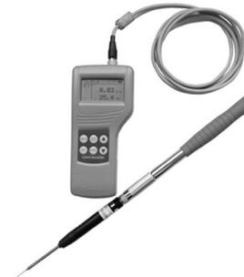
学校で通常用いられる**熱線式風速計**は、電熱線を環境中に露出させて通電し、その発熱と風による冷却とが平衡したときの温度から風速を求めるものである。
