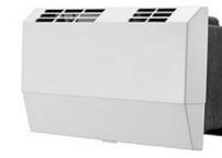
熱交換型換気扇(第1種換気に相当)は、排気通路と給気通路を交差するように形成し、その交差点に熱交換機を設けて、それぞれの空気の全熱を交換させることができる換気装置。
